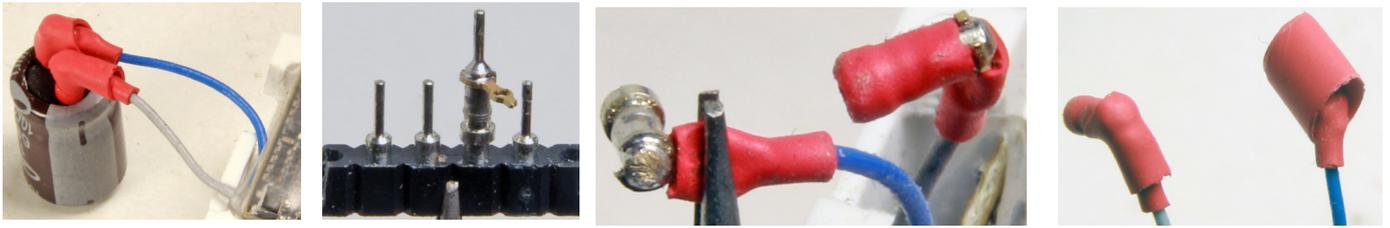
Der Elko wird mit Winkelbuchsen angeschlossen, die ähnlich wie Winkelstecker hergestellt werden. Hierbei wird nicht der Buchsenteil, sondern der Steckerteil abgetrennt. Schrumpfschlauch am Kabel 1,6mm, über den Winkel wird ein 3,2mm Schrumpfschlauch geschoben.
